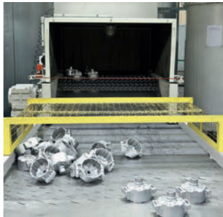
Das Foto zeigt den Auslauf einer Drahtgurtstrahlmaschine mit gestrahlten Teilen. Quelle: AGTOS
