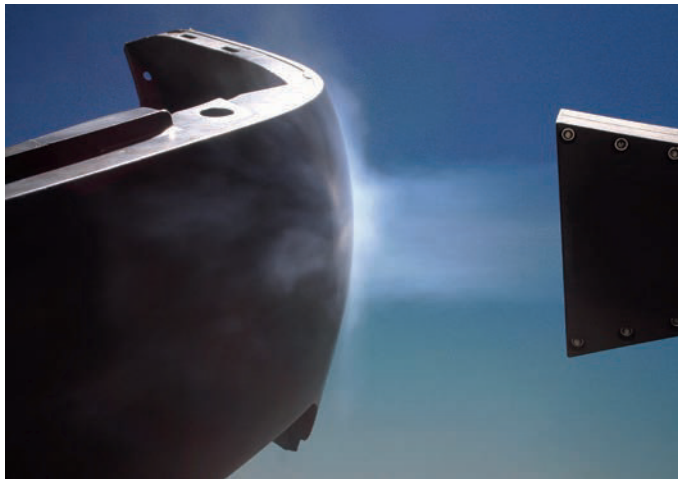
Das Trockeneis trifft mit hoher Geschwindigkeit auf die zu reinigende Oberfläche und geht vom festen in den gasförmigen Zustand über. Dabei werden Verschmutzungen rückstandslos entfernt. Quelle: Linde
